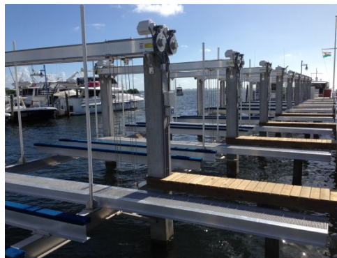
Bådlifte, som løfter motorbåde og speedbåde ud af vandet. Her findes både små og store systemer (fotos: Dutch Blue Marine)
