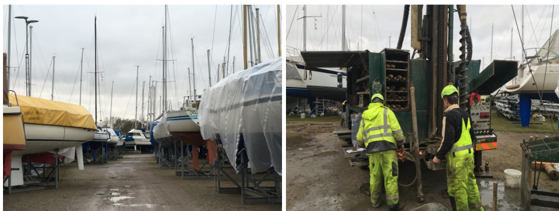
De geotekniske borer har bl.a. kortlagt hvor langt der er ned til fast bund, hvad der er fyldt op med og hvor grundvandsspejlet står. Andre undersøgelser handler om forureningstilstanden.
