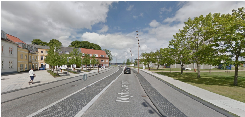
Nyhavnsgade, Aalborg. Eksempel på bygade med gennemgående midterhelle (Google Streetview)
